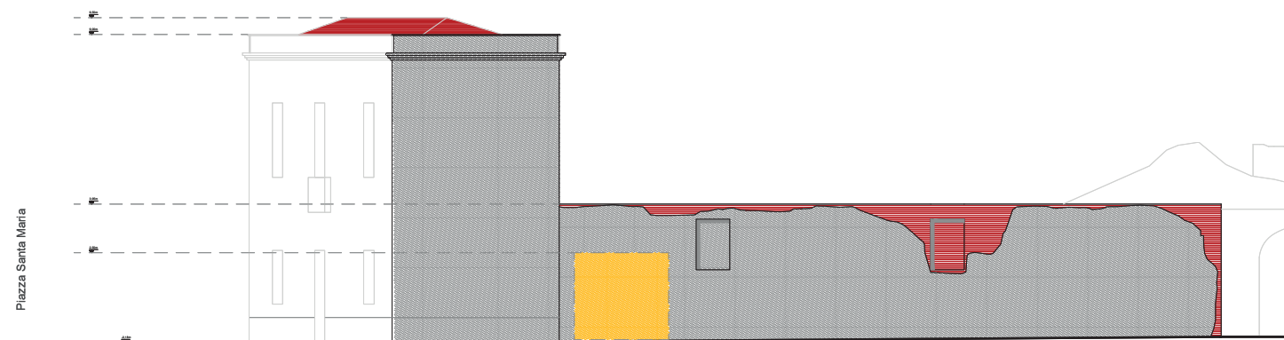
Progetto - prospetto su Via Santa Maria Interventi di consolidamento e ripristino sui muri esistenti 1:100
